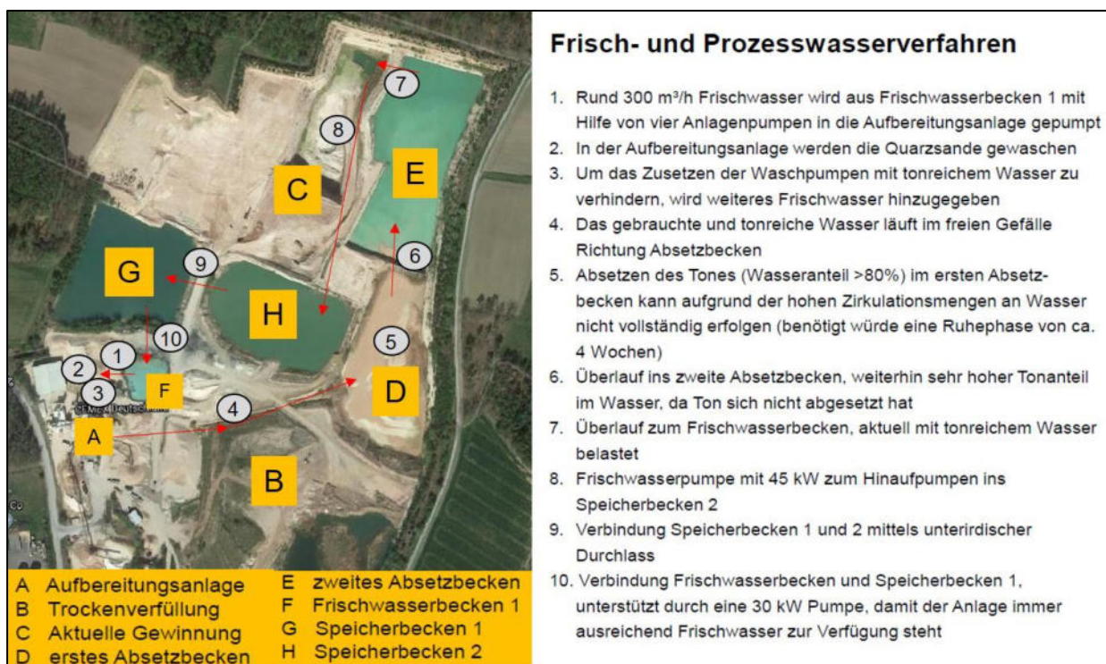
Abbildung 5: Darstellung des Frisch- und Prozesswasserkreislaufes (unmaßstäblich, Hintergrund WMS-Dienst „Google Hybrid“)
