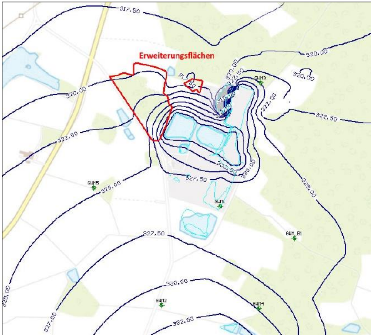
Abbildung 4-2: Vom hydrogeologischen Modell berechneter Hydroisohypsenplan für den Ist-Zustand /4/
