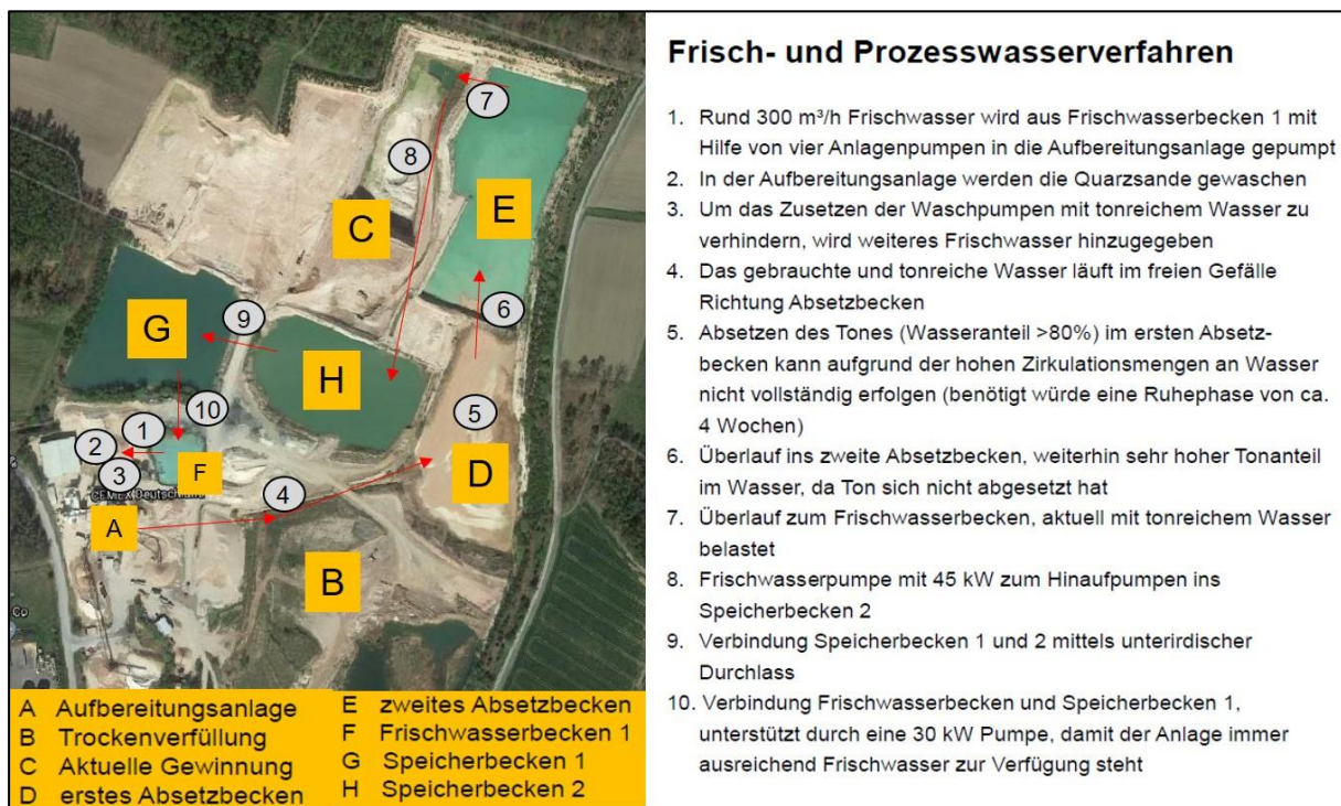
Abbildung 4-3: Orthophoto des Quarzsandwerkes Wellmersdorf (Stand 2021) mit Lage der Becken bzw. der Aufbereitung sowie Beschreibung des internen Wasserkreislaufes /5/
