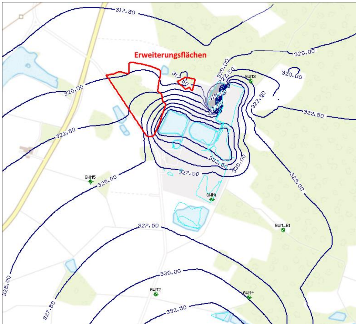
Abbildung 23: Hydroisohypsenplan berechnet nach Modellkalibrierung für den Bereich des Tagebaus Wellmersdorf
