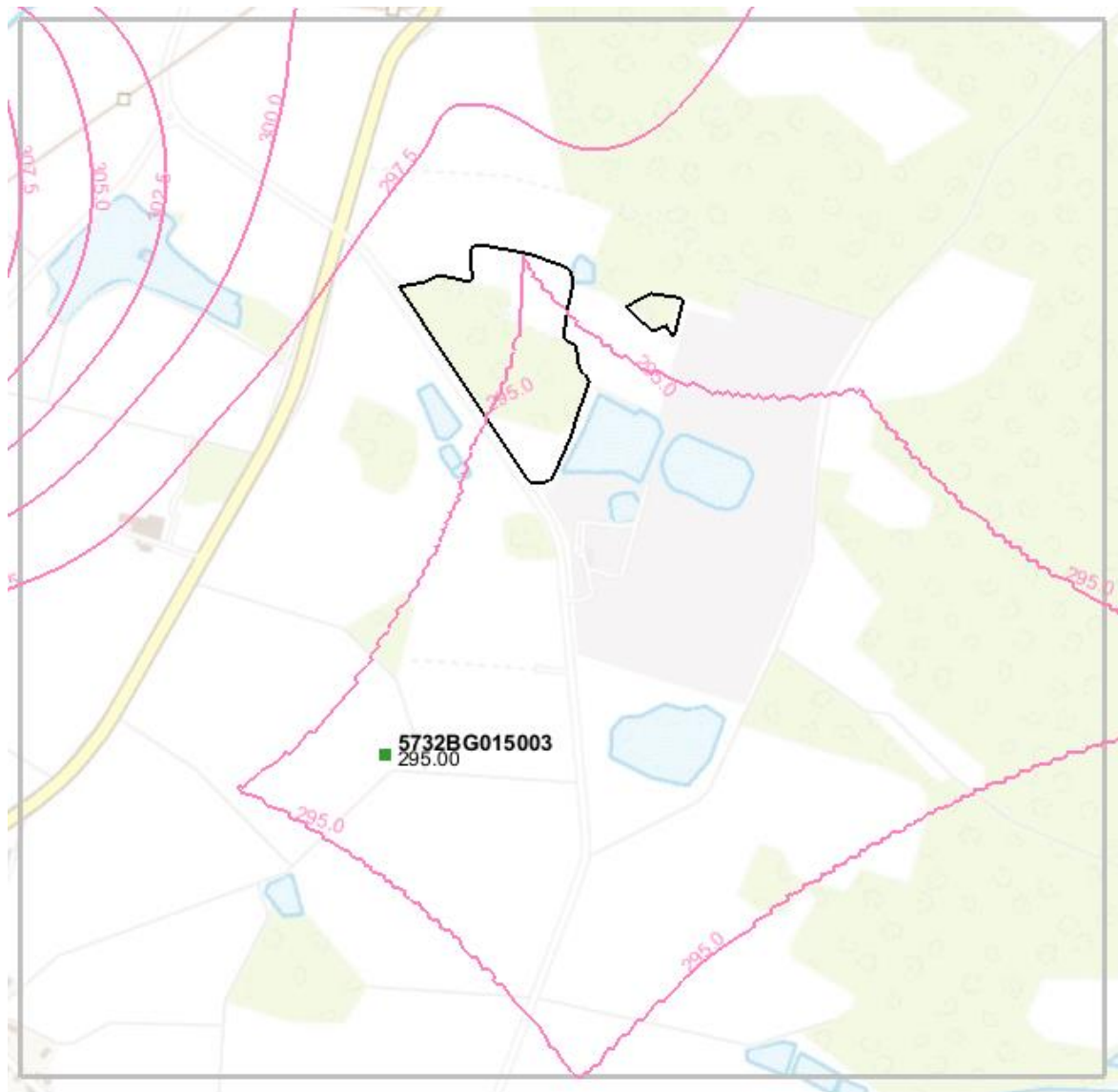
Abbildung 7: Basisunterkante mittlerer Buntsandstein im Bereich des Tagebaus Wellmersdorf mit Nachweispunkten
