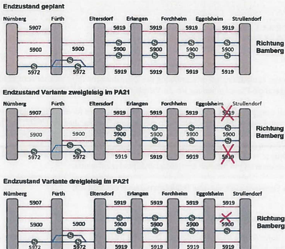
Bild 1: Spurplan Nürnberg – Strullendorf mit Fahrweg der S-Bahn und Ausbauvarianten Eggolsheim – Strullendorf
