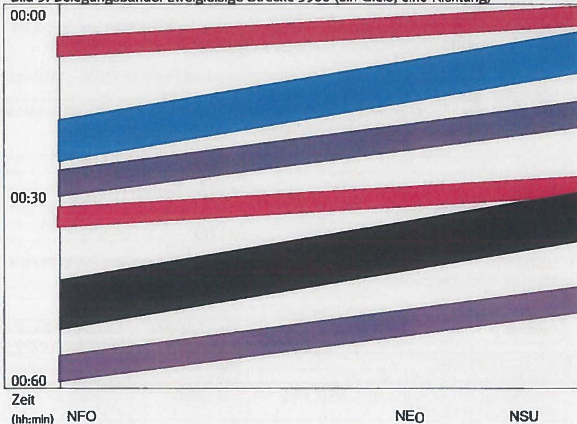
Bild 3: Belegungsbander zweigleisige Strecke 5900 (ein Gleis, eine Richtung)
