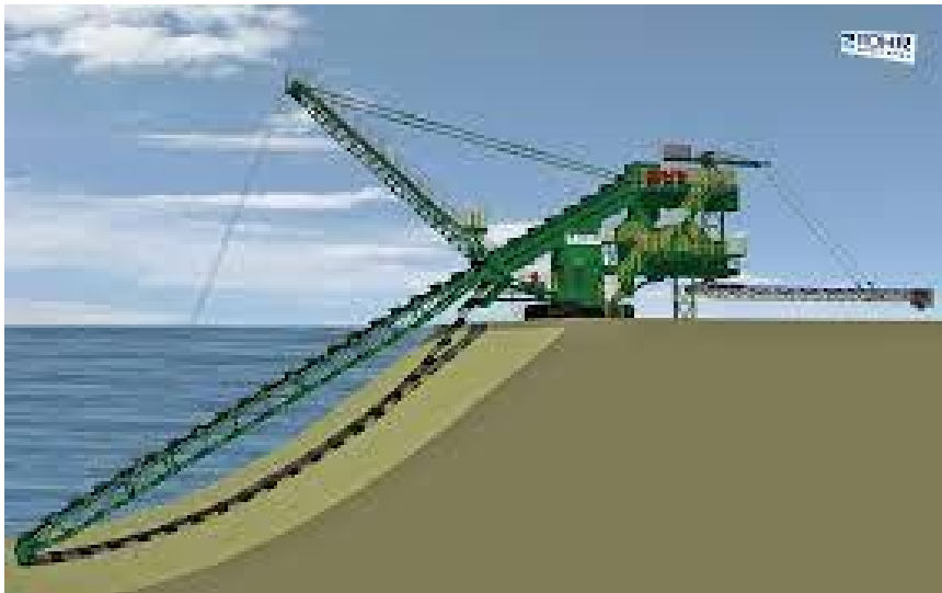
Abbildung 5-1: Prinzipdarstellung Nassgewinnung mittels landgestützten Eimerkettenbaggers
