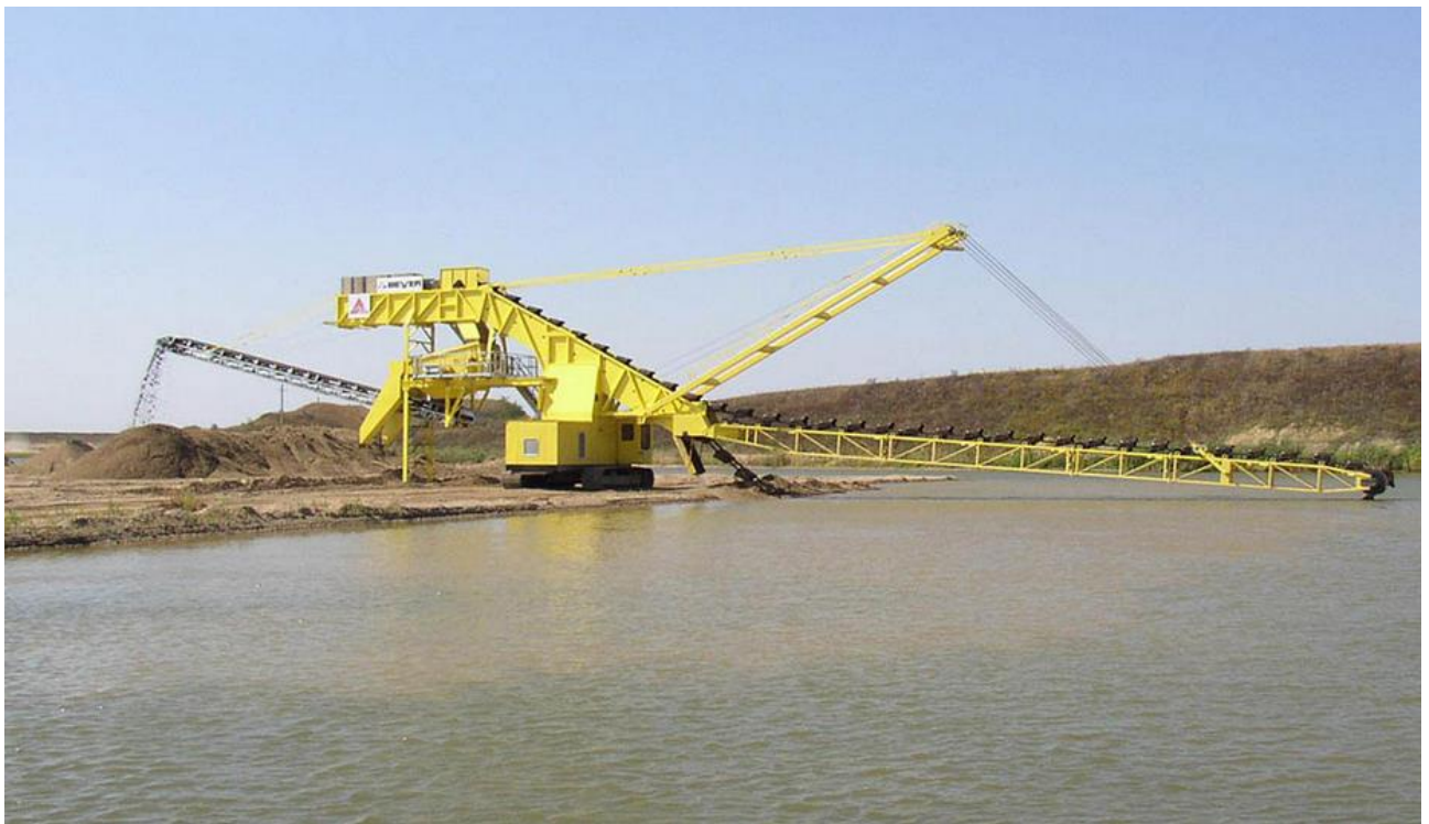
Abbildung 6-1: Beispielhafte Darstellung eines landgestützten Eimerkettenbaggers zur Kiesgewinnung (anderer Hersteller - Abb. beyer-suedost.de)
